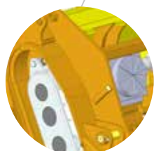
Шестерённые боковые приводы занимают мало места · Встроенная система охлаждения боковых редукторов
