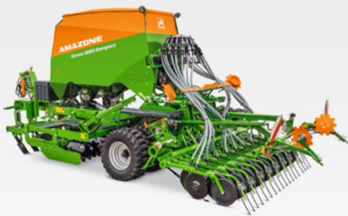
Cirrus 3003 Compact с двухдисковым сошником TwinTeC +
