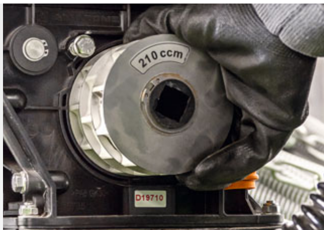
Дозирующие катушки для различных видов посевного материала
