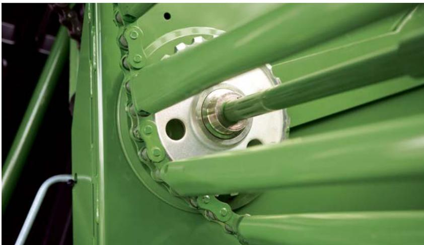
Направляющий ролик с цепочно-трубчатым транспортером
