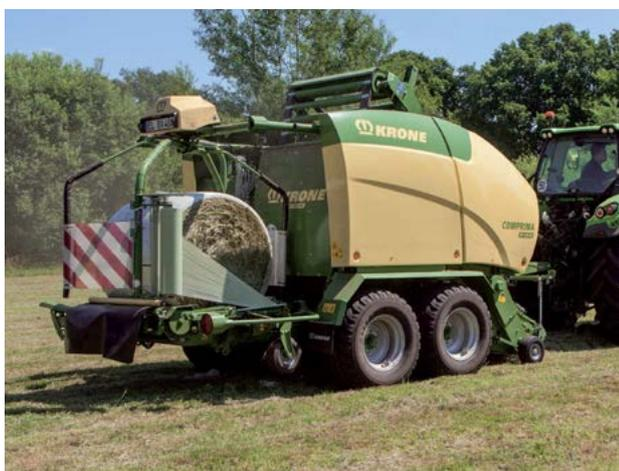
**Полувариационная комбинация пресс-подборщика с обматывающим устройством Comprima CF 155 XC**
