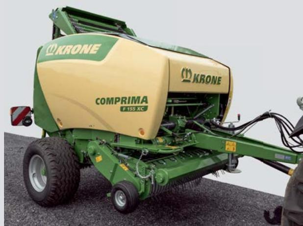
борщиками с регулируемой прессовальной камерой они имеют более привлекательную цену, не требуют больших затрат на техническое обслуживание и удобны для сервисного обслуживания. Он может укладывать рулоны различного диаметра, уплотнять снаружи вовнутрь, а тюки большего диаметра имеют относительно небольшую, мягкую сердцевину. В итоге рулоны имеют большой вес.
