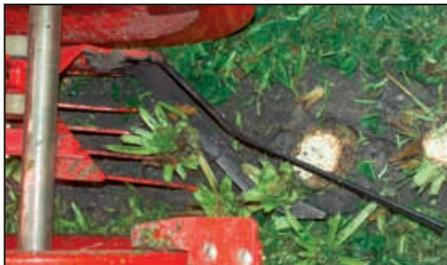
*Роторный дообрезчик обеспечивает наилучший срез головок корнеплодов при различных почвенных условиях, благодаря, точному копированию свеклы гребенкой. Идеален при высокой засоренности полей; он работает свободно от забивания сорняком.*
