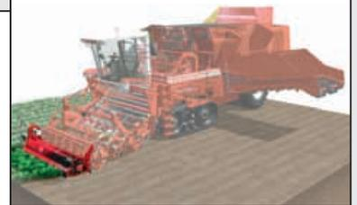
Преимущества системы «INLINE»: идеальная уборка челночным способом. Измельченная ботва корнеплодов направляется в междурядья. С помощью вакуумного эффекта системы «INLINE», полёгшая ботва будет также измельчена. Большие опорные колеса прикатывают измельченную ботву и предотвращают забивание, убранной ботвы, на ножах дообрезчиков.
