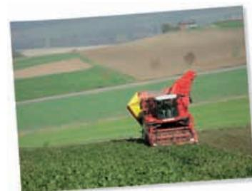
На склонах Швейцарии MAXTRON 620, благодаря активному выравниванию на склонах, остается в колее.
