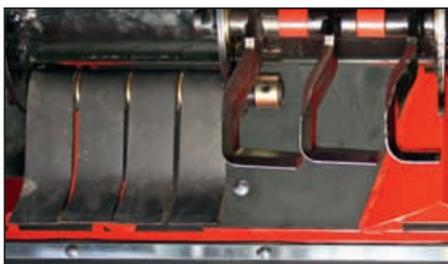
Максимальная производительность: высокопроизводительные ложечкообразные ножи (слева) убеждают высоким вакуумным эффектом. Альтернативно, возможно оснащение L-образными ножами (справа), которые реализуют чрезвычайно тонкое измельчение ботвы при низком расходе дизтоплива.
