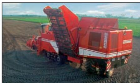
Диапазон числа оборотов до 1350/минуту экономит горючее с помощью системы для автоматической регулировки числа оборотов двигателя. MAXTRON 620 с двигателем Mercedes-Benz располагает официальным разрешением для использования биодизельного топлива типа «RME».
