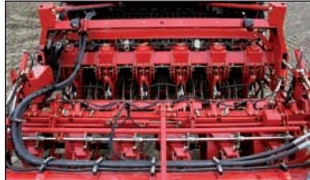
*Гибко и комфортно: регулировка расстояния междурядий гидравлическим способом (опционально).*
