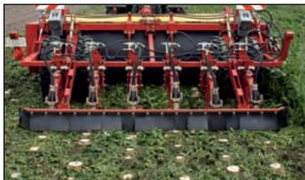
Оставляет желанный результат: Опционально можно приобрести роторный дообрезчик с гидропроводом, который даже в самых сложных условиях обеспечивает, постоянно, точный срез.
