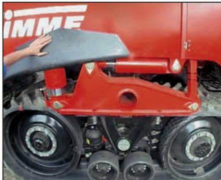
*Бережет механизатора и машину: Амортизирующая передняя ось на гусеничном ходу для комфортного передвижения по дороге и на краю поля.*
