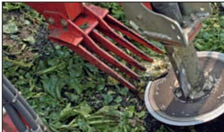
*Отличное контурное ведение и наилучший срез корнеплодов, при различных почвенных условиях производится, благодаря, центральному расположению 7-ми больших копирующих колес.*
