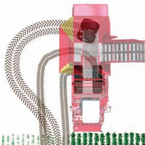
Манёвр вне критики: оптимальный радиус разворота предотвращает частые и для почвы вредные маневры разворота и движения. Поперечные поездки на краю поля сокращаются. Внутренний радиус разворота составляет лишь 1 м.
