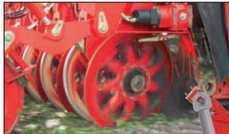
*Чистая работа: Дисковые копачи с гидравлическим приводом бережно поднимают корнеплоды из земли и передают на сепарирующую часть.*
