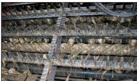
Интенсивная очистка: очистка спиральными вальцами при самых тяжелых условиях.
