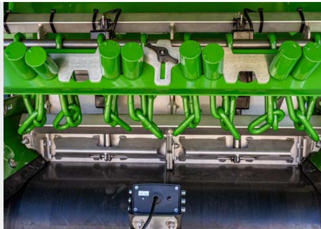
Двойная заслонка с электрической регулировкой
