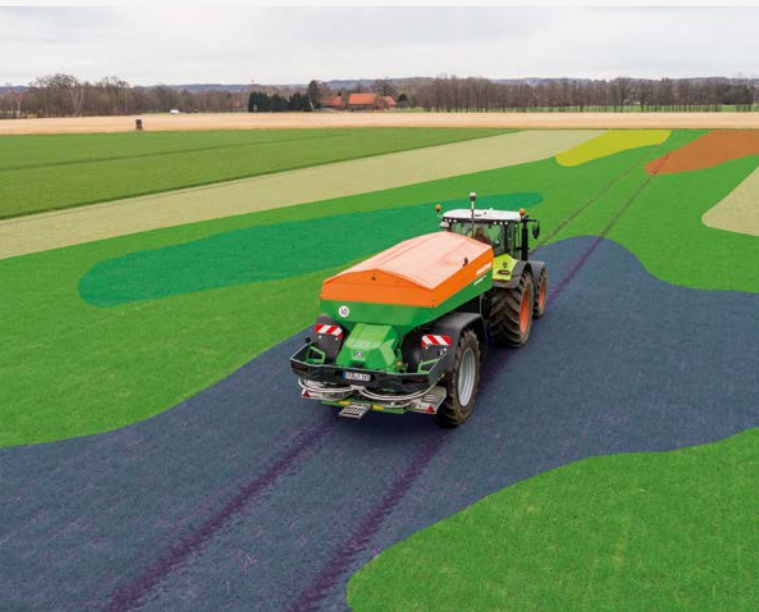
Переменная норма при дифференцированном внесении удобрений
