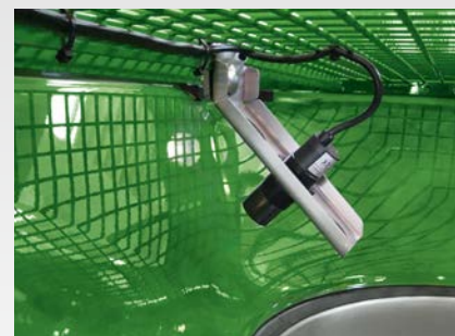
✓ Датчик опустошения бункера на ZA-TS
