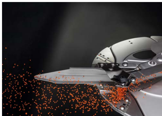
AutoTS – настройка направляющей лопатки для пограничного распределения
