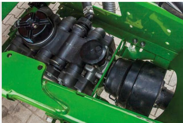
UX Special может быть оснащен насосами производительностью 260 л/мин или 380 л/мин.
