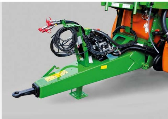
Дышло с нижним зацеплением с прицепной серьгой и механической стояночной опорой
