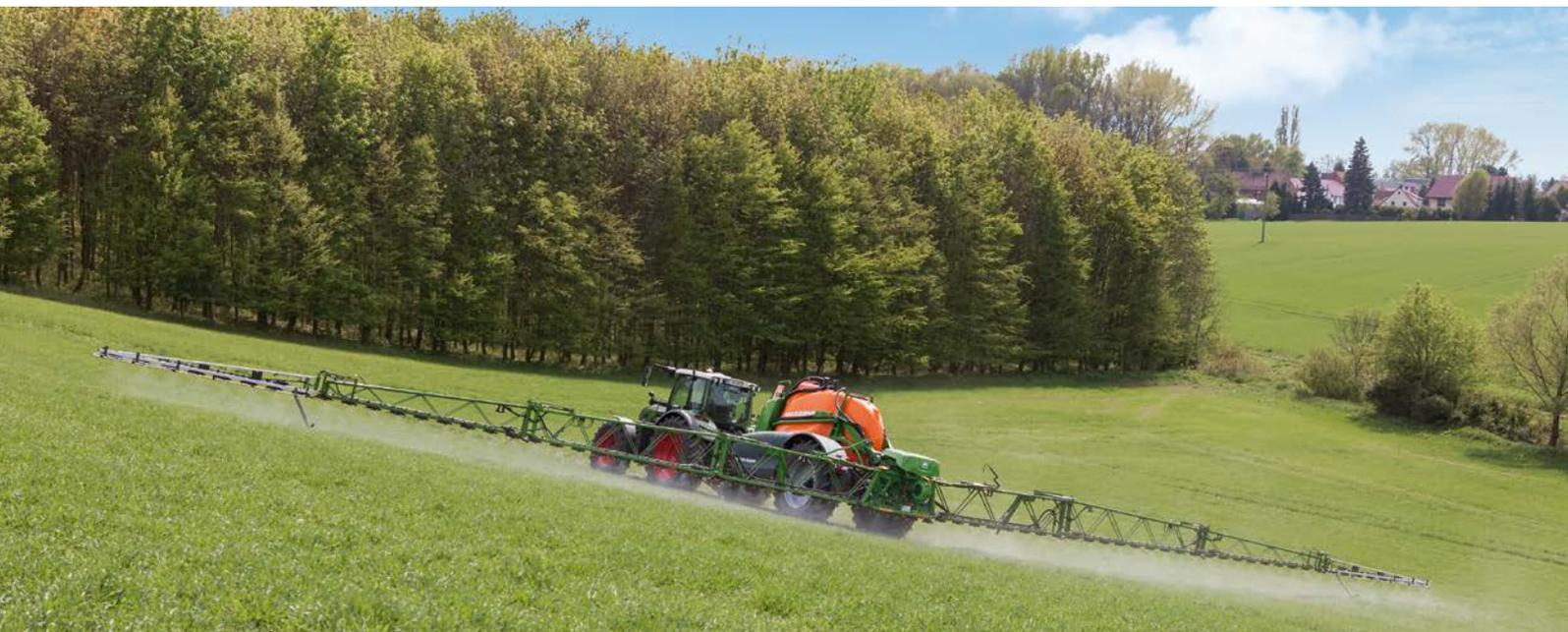
Складывание Flex 2 с функцией ContourControl обеспечивает оптимальное ведение штанги
