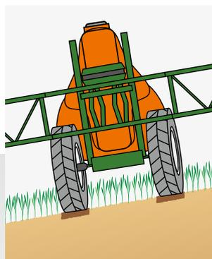
Активированная регулировка на склоне при рулении AutoTrail
