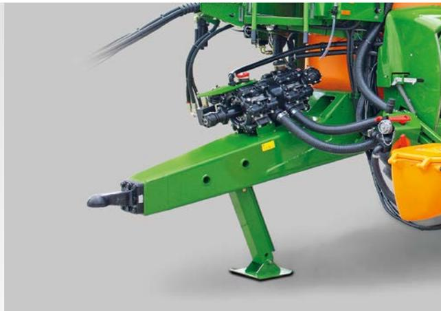
Дышло Hitch, жёсткое, с гидравлическим приводом насоса
