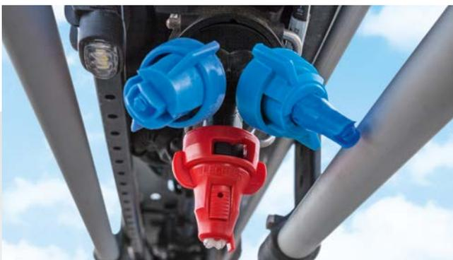
Электрическое пофорсуночное включение AmaSwitch
