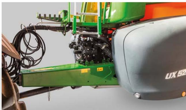
Система с двойным насосом UX Super достигает производительности до 520 л/мин
