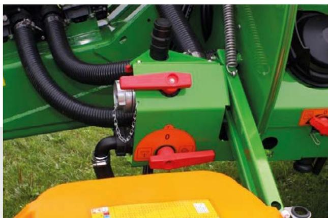
Подключение инжектора на UX Special обеспечивает производительность заполнения до 500 л/мин.
