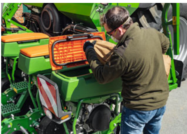
Семенные бункеры отличаются удобным доступом и позволяют пользование одной рукой
