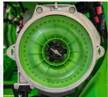
Дозирующий диск в действии (без крышки)
