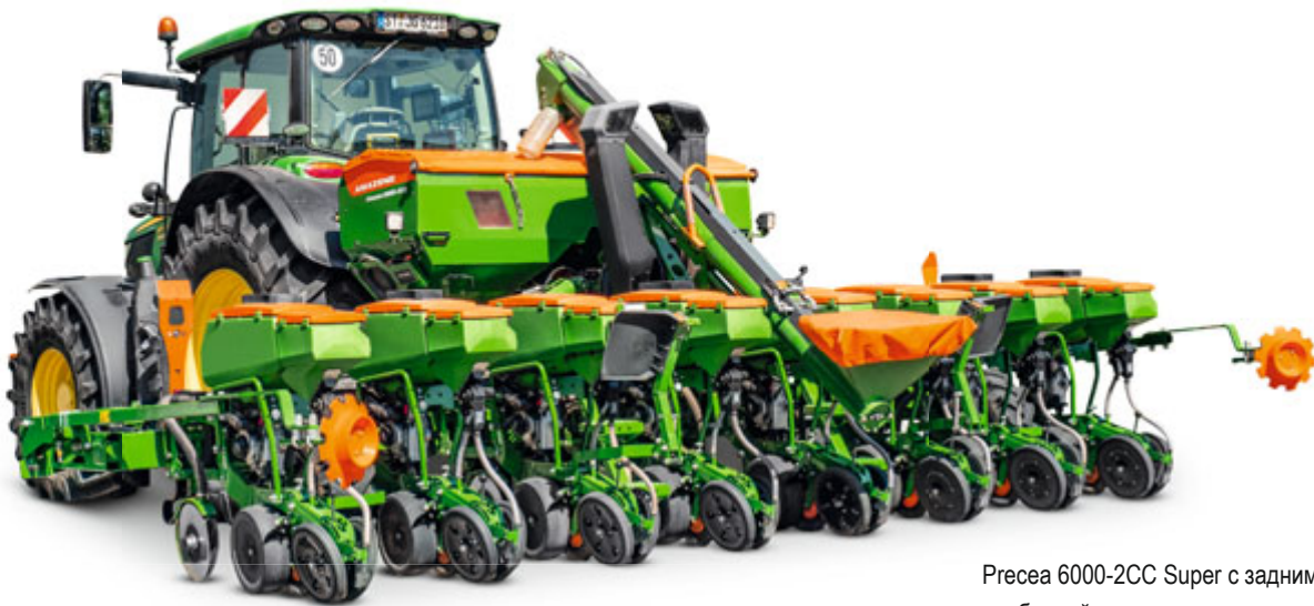
Пресеа 4500-2CC Super с задним бункером для удобрений и загрузочным шнеком
