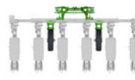
6 рядов с опорными колесами между рядами
