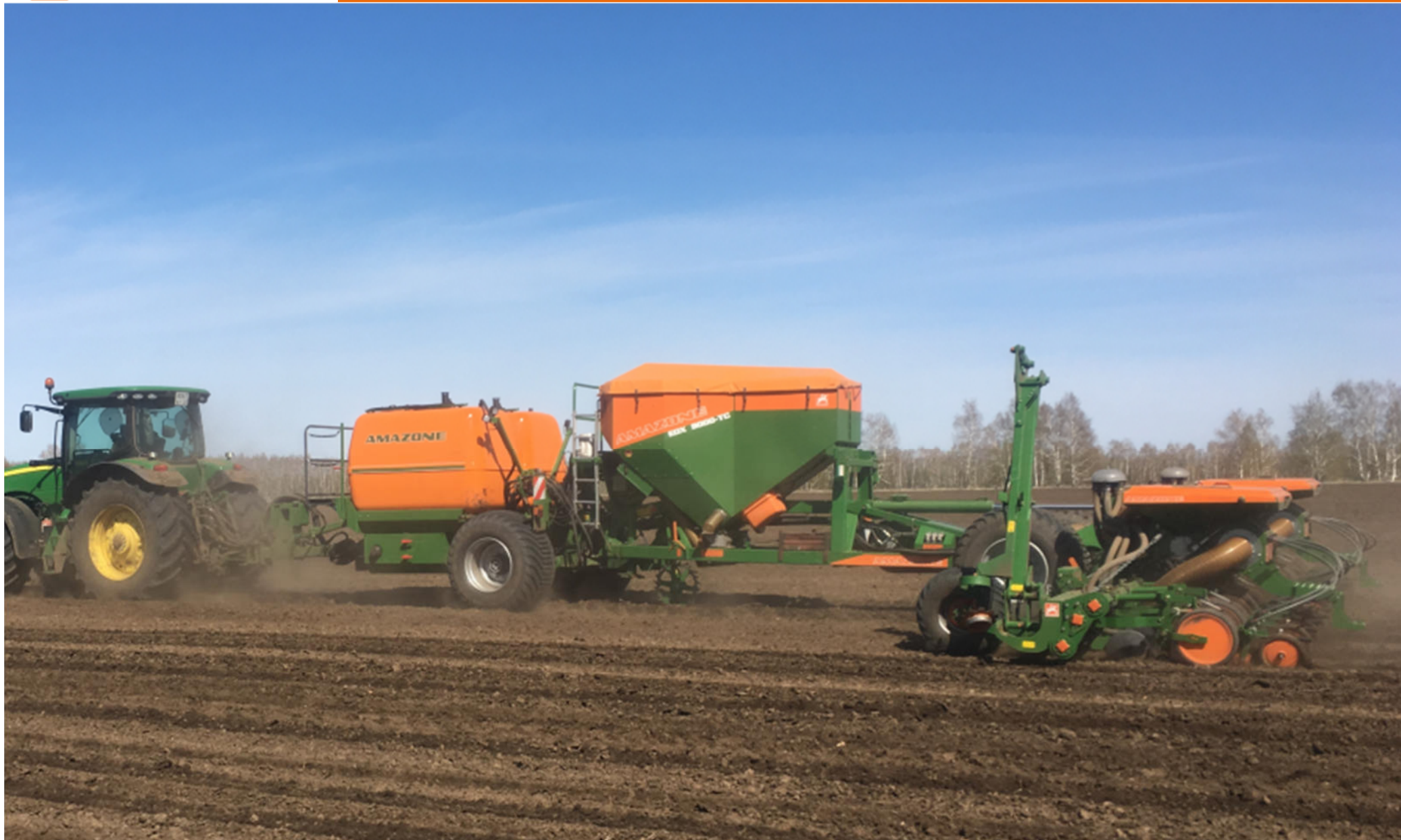
Прицеп для жидких удобрений FDC - работа с EDX
