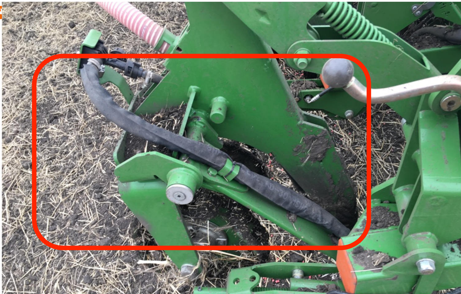
Прокладка шлангов с защитой
