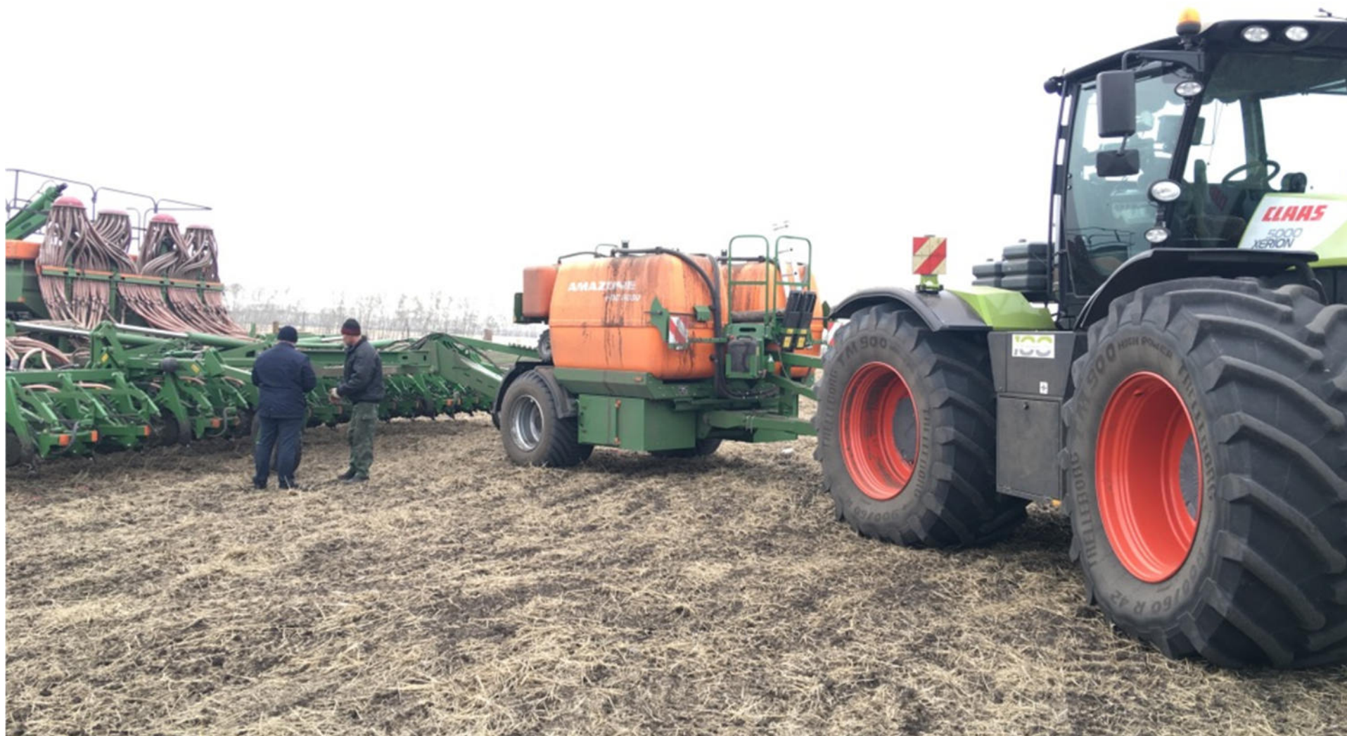
Прицеп для жидких удобрений FDC - работа с DMC 12001
