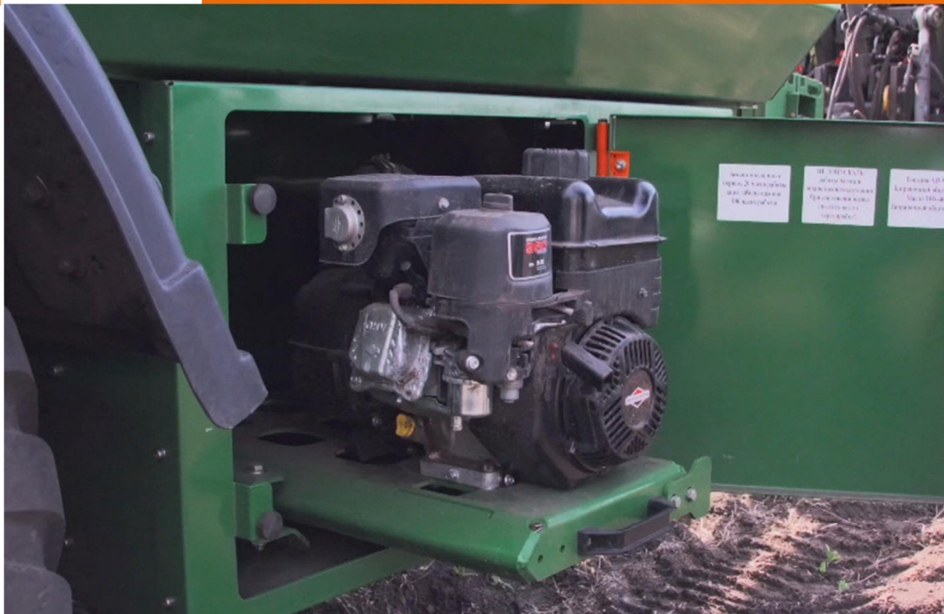
Насос для загрузки КАС/ЖКУ 500 л/мин
