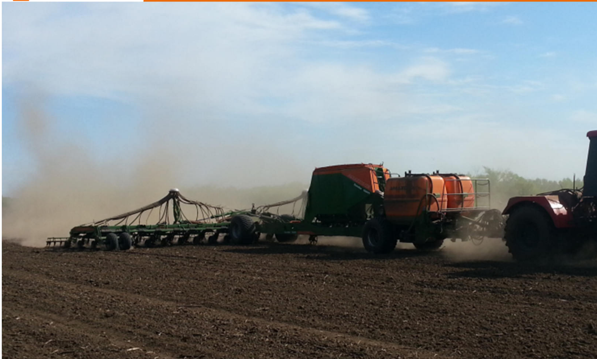
Прицеп для жидких удобрений FDC - работа с Condor
