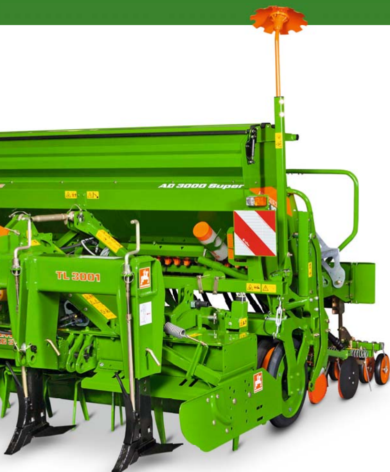
Насадная сеялка AD в комбинации с глубокорыхлителем TL, ротационным культиватором KG и резино-клиновым катком KW
