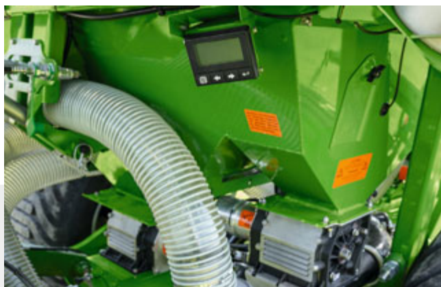
Primera DMC с сервоприводом дозирования и терминалом TwinTerminal 3.0
