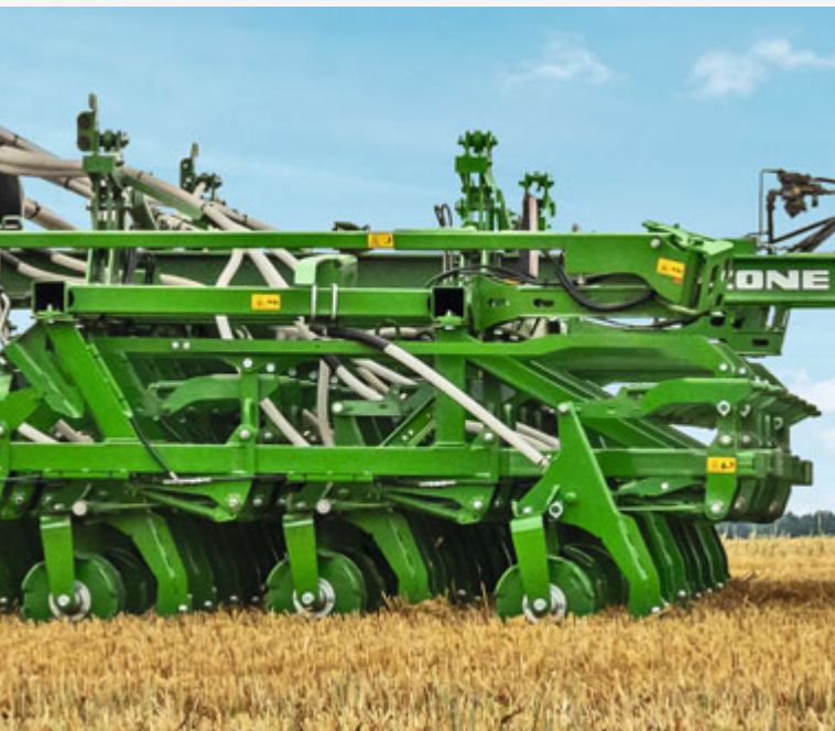
Параллелограммная подвеска долотовидных сошников
