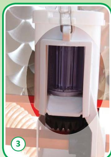
1 Легкий в управлении **вolumетрический распределитель** MINIMAX позволяет осуществлять распределение удобрений в разной дозировке, сохраняя высокую распределительную точность: 50-700 кг/га.
