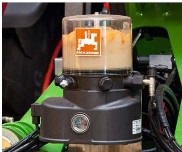
Насос с резервуаром для смазки
