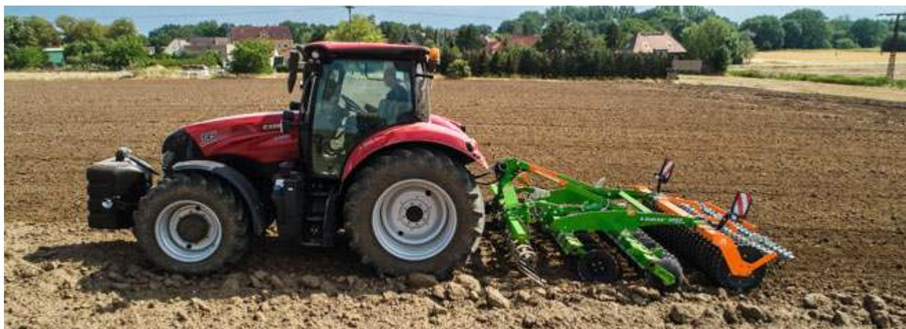
Крупные комки земли измельчаются выравнивателем Crushboard перед первой батареей дисков и обеспечивают еще более высокий результат работы
