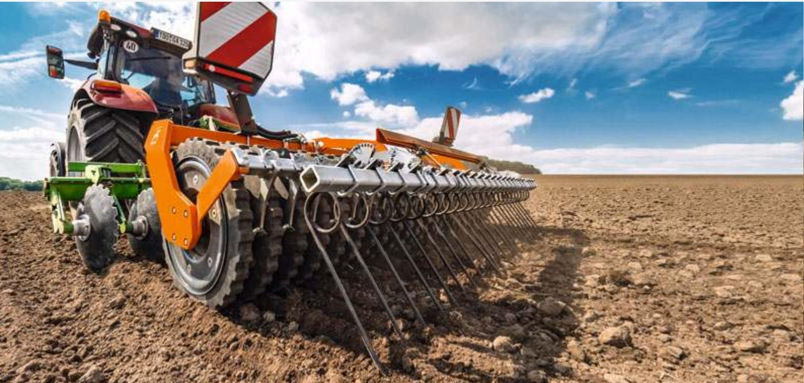
Навесная компактная дисковая борона Catros<sup>+</sup> 03 идеально подходит для быстрой поверхностной обработки почвы с интенсивным смешиванием. Простая и бюджетная навесная компактная дисковая борона с глубиной обработки от 5 до 14 см является идеальной моделью начального уровня для малых и средних хозяйств.
