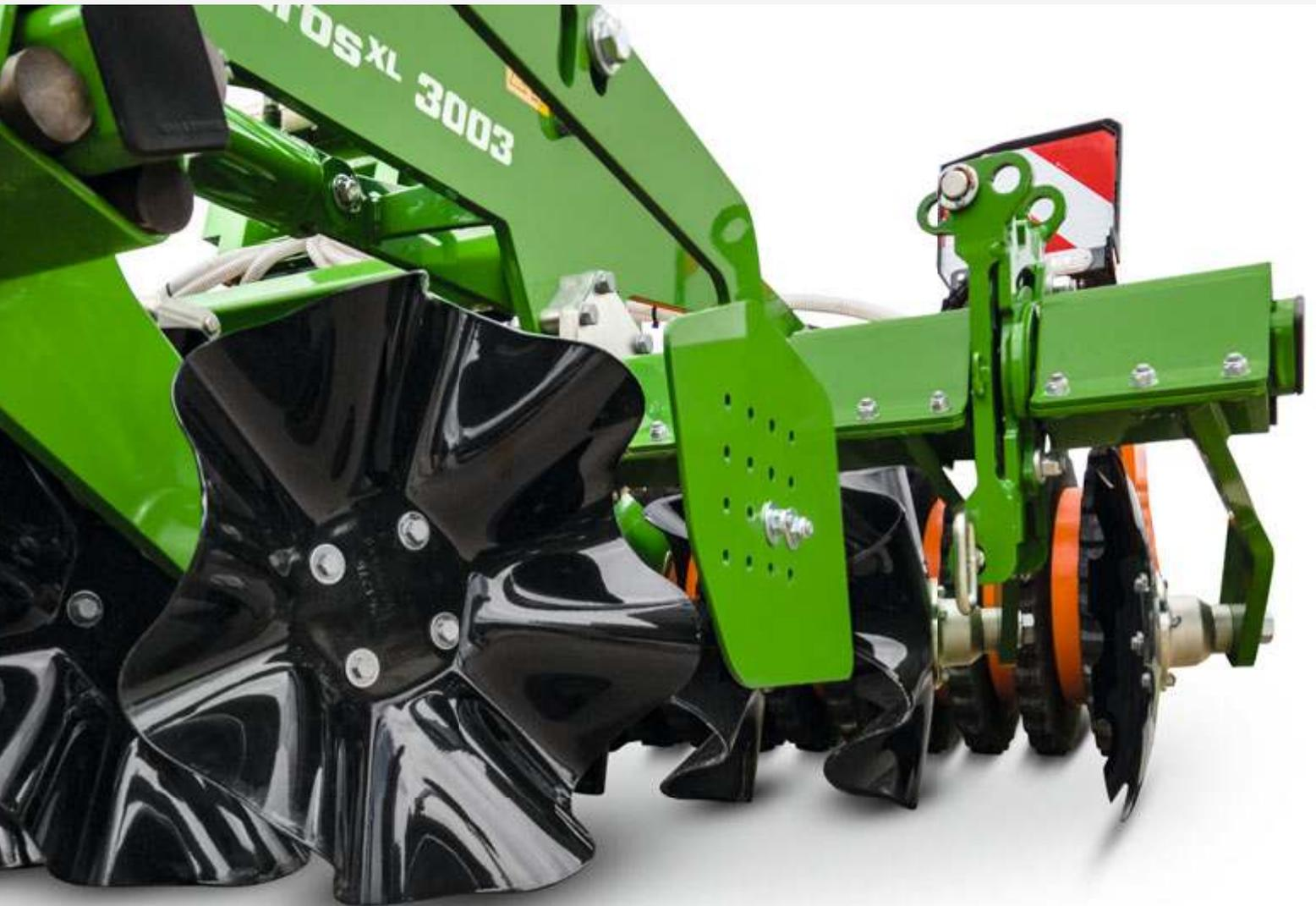
Диск X-Cutter выполняет сплошную обработку на небольшой глубине благодаря специальному волнистому профилю
