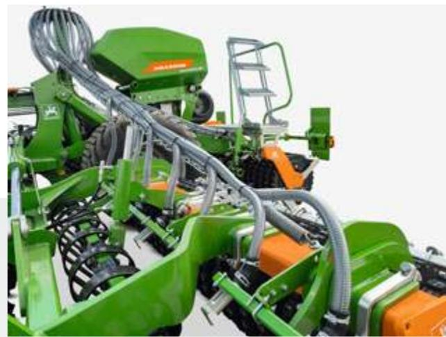
Высокая гибкость за счет сегментной распределительной головки
