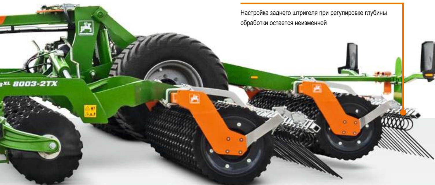
Настройка заднего штригеля при регулировке глубины обработки остается неизменной
