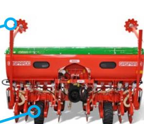
**Загрузочный бункер из окрашенного листового металла емкостью 1.200 литров или из нержавеющей стали емкостью 850 литров**
